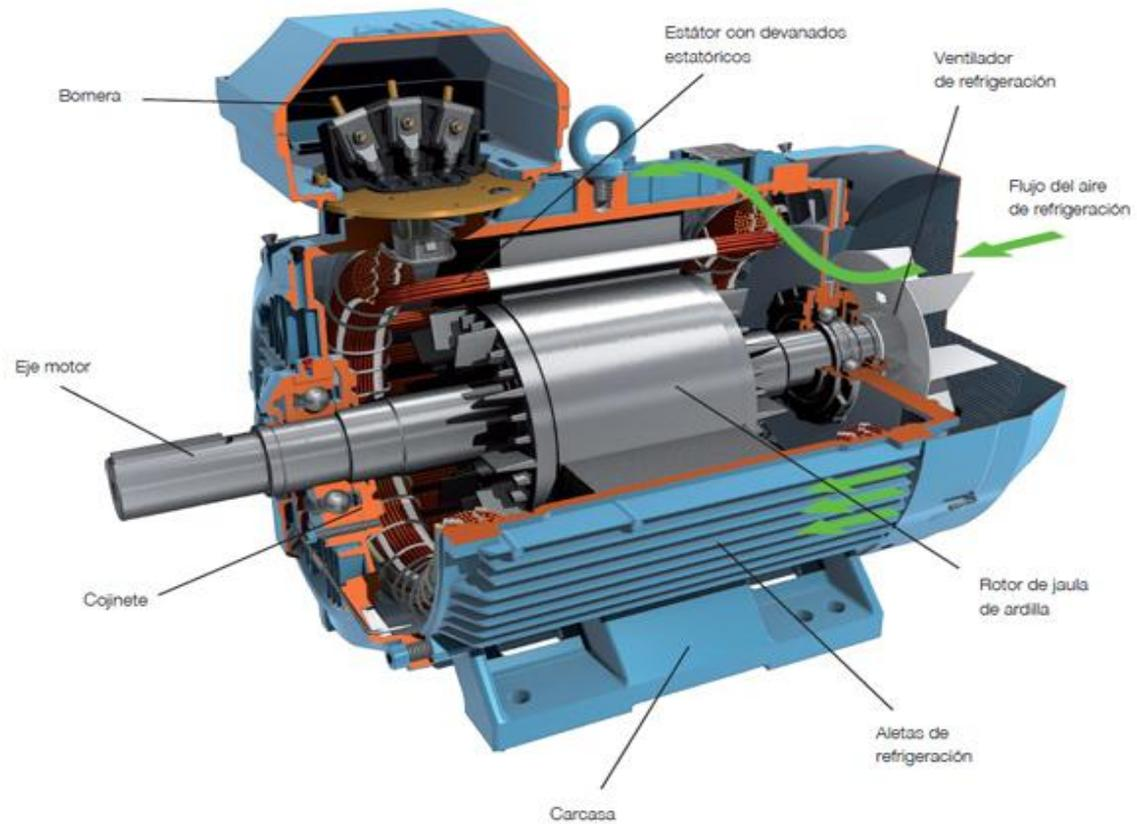
Un motor se considera asíncrono cuando la velocidad de giro del campo magnético del estator supera la velocidad de giro del rotor.
